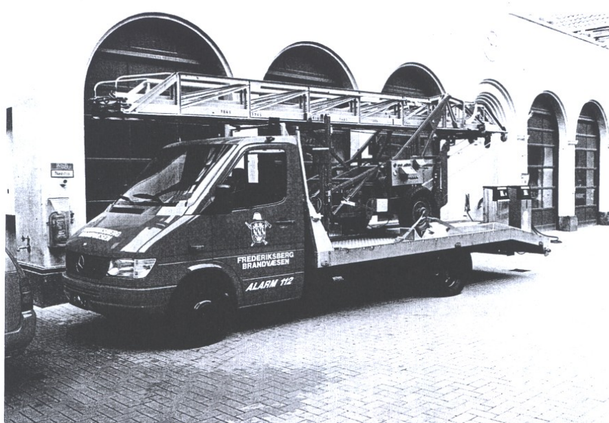
Afprodsstigen, S-10 en MB 412D Sprinter. Selve stigen er fra den gamle MB 1113-afprodsstige, som man købte af København. Foto John Hou
