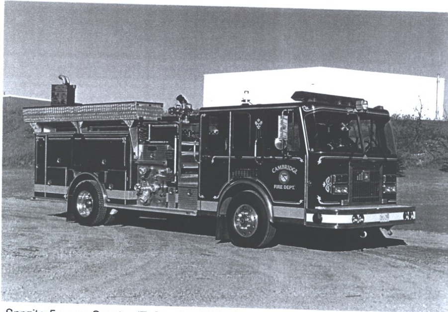
Sprøjte 5 er en Spartan/E-One fra 1990. Pumpen yder 4731 liter i minuttet og vandtanken er på 1893 liter. Foto Rick Maguire.
