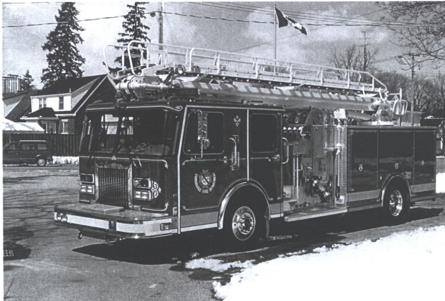
Stigesprøjte 4 en Spartan/Saulsbury fra 1995. Stigen - hvis man kan kalde den det - går 15 meter op. Pumpen yder 4731 l/m. Foto Rick Maguire.
