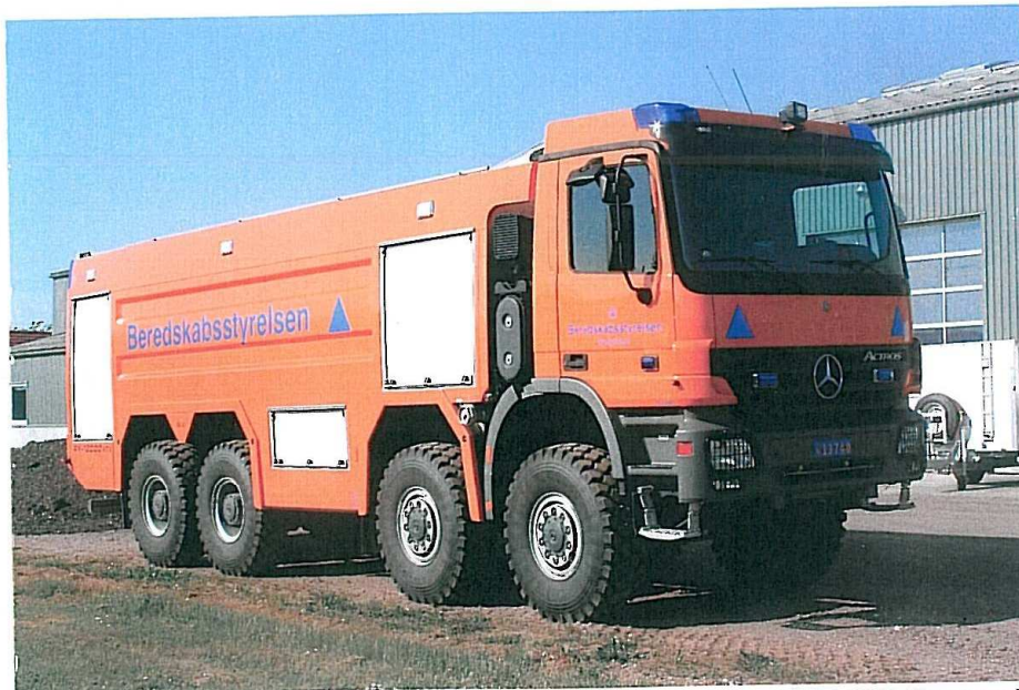
Prototypen af Beredskabsstyrelsens nye terræntankvogn med 14.000 liter vand, bygget af HMK Ringe på et Mercedes Actros 4150 8x8 chassis. Fotos Lars Larsen
