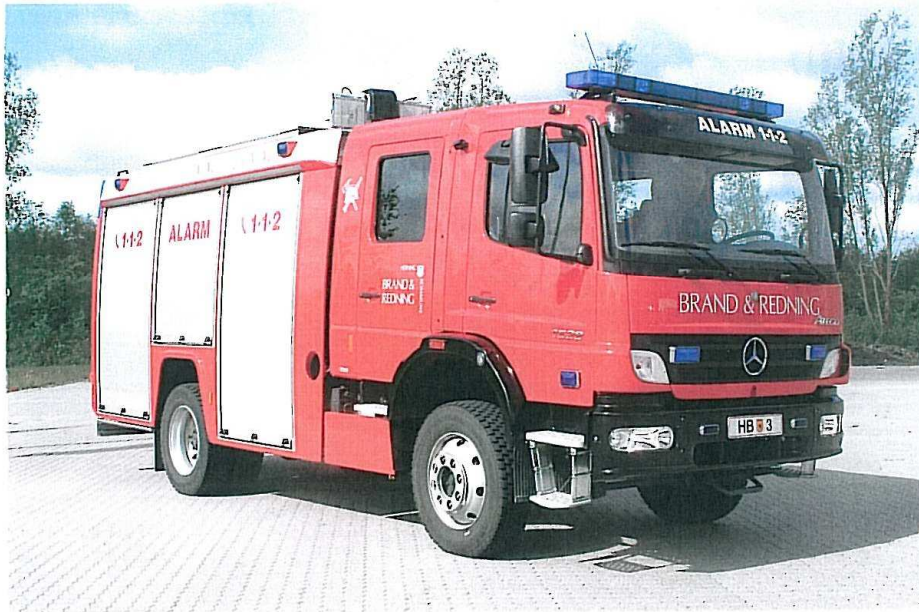
Herning Kommunale Beredskab en Mercedes Benz 1528 med 2.400 l. vandtank
