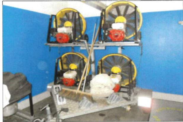
Lidt ekstraudstyr, fire stk. overtryksventilatorer ... Foto: TFR
