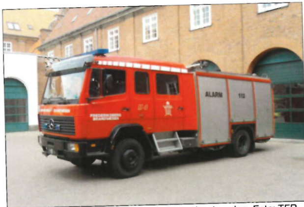
FB M4. MB 1320 med Rosenbauer (Norge) opbygning. Foto: TFR
